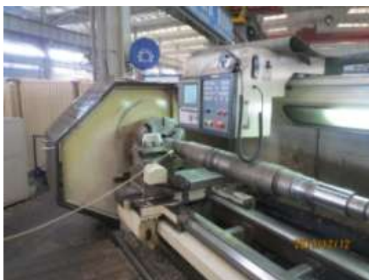
某型核泵主轴表面纳米化处理现场
