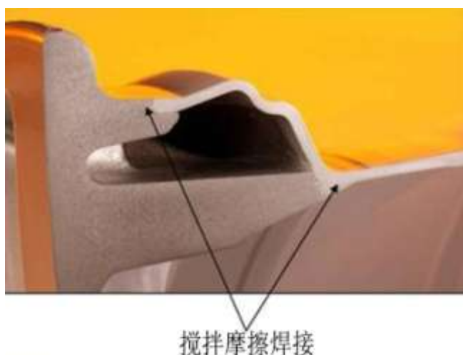
轮毂分体制造-搅拌摩擦焊接示意图
