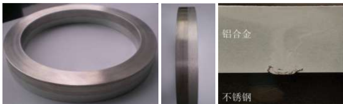
大厚度铝合金/不锈钢搅拌摩擦搭接焊接接头
