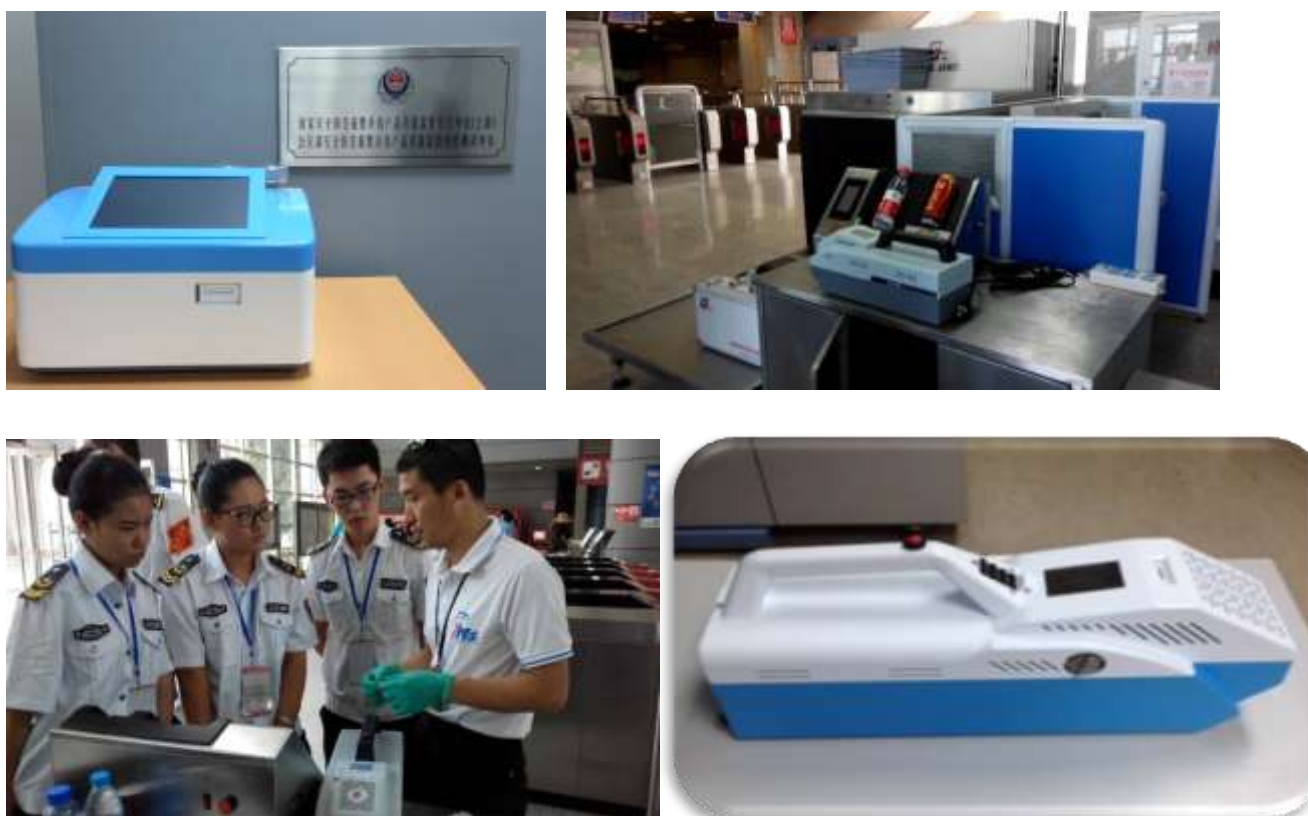
图 3 台式、便携式炸探仪器及在现场的应用实例
