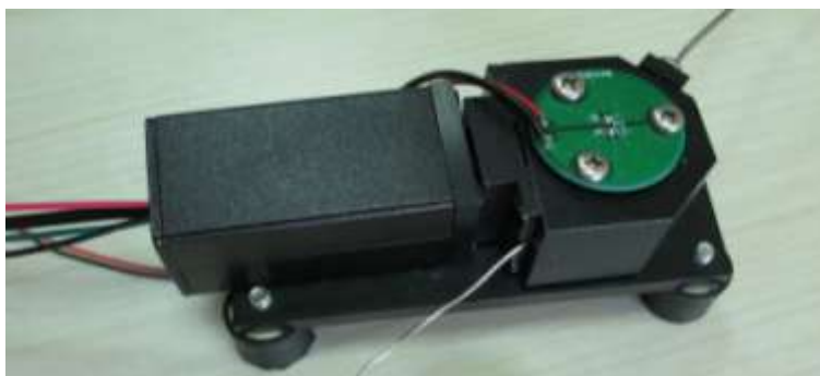
黄曲霉毒素荧光检测器。检测下限 6 ppt (w/w)
