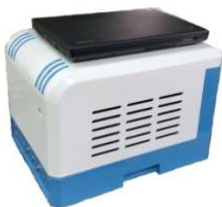
图 2 全封闭组合电器电气故障在线诊断仪以及 \text{SF}_6 放电产物在线检测谱图
