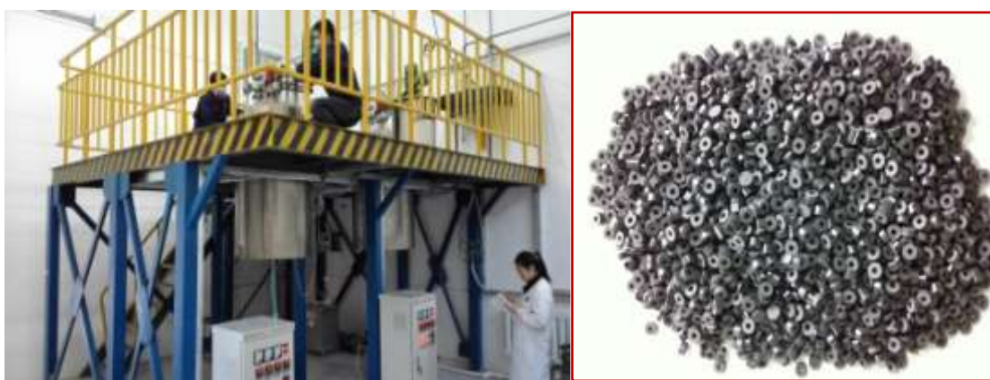
催化剂的放大制备丙烷选择氧化制丙烯酸环形催化剂
